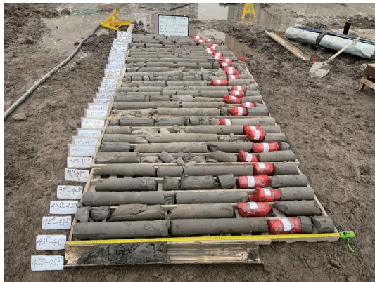
图 15 TRD 现场取芯试样 Fig. 15 TRD on-site core sampling sample
