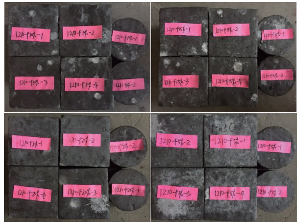
图 6 不同粉煤灰含量的石墨混凝土试块 Fig. 6 Graphite concrete specimens with different fly ash contents
