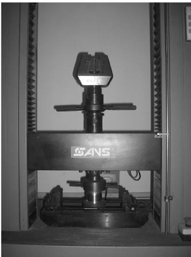
图 1 试验用 SANS 电子万能试验机
