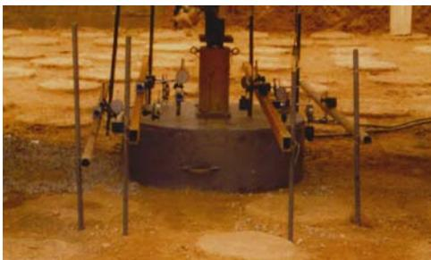
图 3 单桩复合地基载荷试验系统现场试验图
