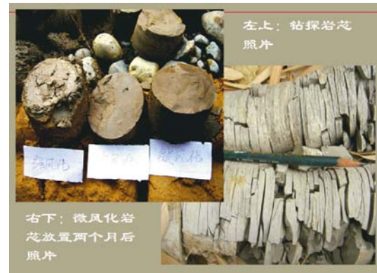
图 1 第三系泥岩钻探岩芯照片
