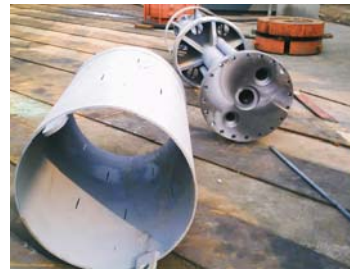
图5 局部气举反循环集渣装置
