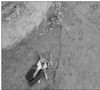
图5 水泥浆劈裂平面图
