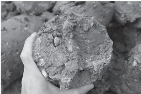
图5 第二阶段勘察部分钻孔取样体大样
