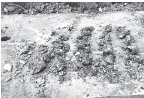
图2 第一阶段勘察部分钻孔取样体大样
