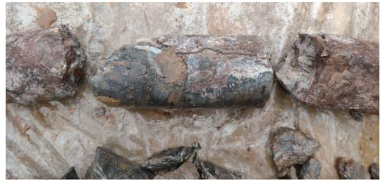
图2 钻孔揭露构造角砾岩
