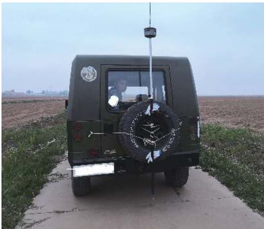
图4 改装移动测量车
