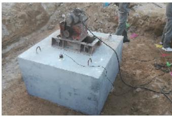
图3 旋喷桩复合地基模型基础布置实景图
