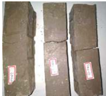
图2 典型冻土样品破坏图
