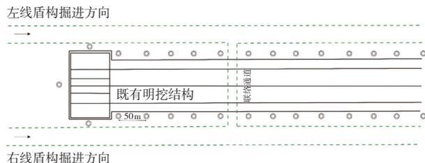
图 6 明挖区间降水井布置平面示意图
