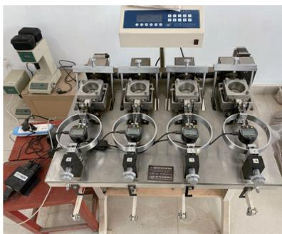
图 2 DSJ-3 型应变控制式直剪仪
