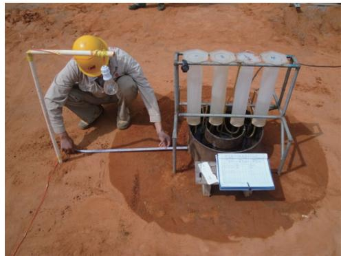
(b) 压实红砂现场双环注水试验
