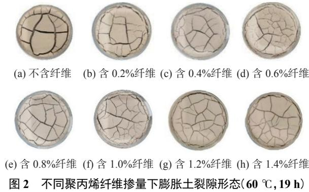
由图2可知,相同的温度条件下聚丙烯纤维改良后的膨胀土较素膨胀土有更多的裂缝,但比素膨胀土表面上的裂缝更加均匀。同时,改良后膨胀土表层的裂缝相对细长、狭窄,裂缝更密集且集中在中心区域,大多数裂缝未形成贯通<sup>[13]</sup>。此外,聚丙烯纤维的数量越少,土中出现的裂缝就越少,但裂缝越宽。聚丙烯纤维含量越多,膨胀土裂隙越小,且呈现越来越密集。从裂隙深度上看,素膨胀土呈现出的裂隙最深,随着聚丙烯纤维掺量增多,裂隙越来越浅,且越来越细。在实际的建筑工程中,如果土体裂缝越长、越宽,那么在强降雨的情况下,水体越容易顺着裂隙渗入土体内部,从而引起土体黏聚力和内摩擦角急剧降低,发生不同程度的变形与破坏。膨胀土干缩裂隙的条数和宽度反映了聚丙烯纤维对膨胀土加固的影响。通过60℃蒸发条件下的膨胀土裂隙情况为例分析,充分说明聚丙烯纤维对膨胀土干缩裂隙的裂缝有明显的抑制作用,且随着纤维含量的增加,抑制作用更加明显。
