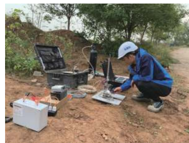
图 3 改进后的钻孔剪切仪现场测试
