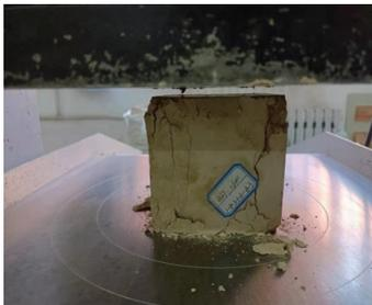
图3 抗压试验破坏图
