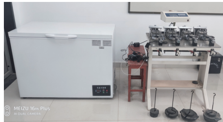
图2 低温试验箱与直剪仪
