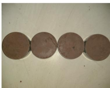
图 1 加工后的原状泥岩环刀样
