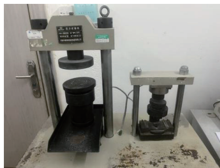
图 1 抗压试验仪器
