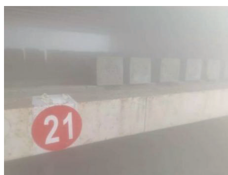
图 2 试样养护照片
