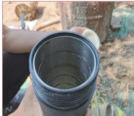
图7 YXTH50型内环刀取砂器
