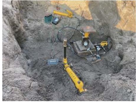
图 2 原位直剪试验仪器布置图
