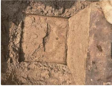
图4 试样剪切破坏面
