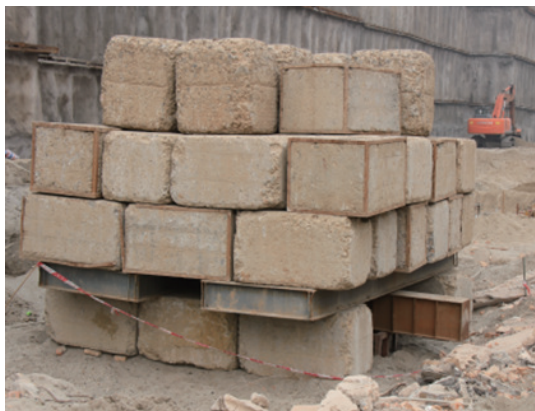
图2 浅层平板载荷试验
