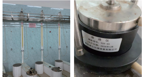
图5 变水头渗透试验仪器
