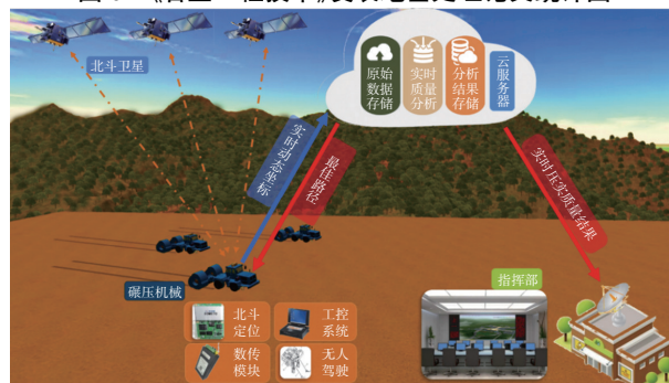
图7 高填方机场压实质量实时监控系统 [28]
