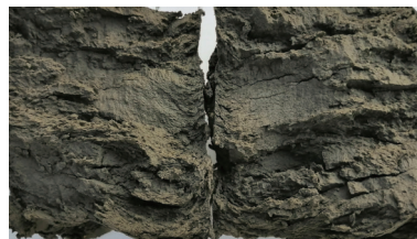
图 5 超轻质火山灰软黏土絮状结构
