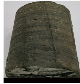
图 1 超轻质火山灰软黏土水平层理
