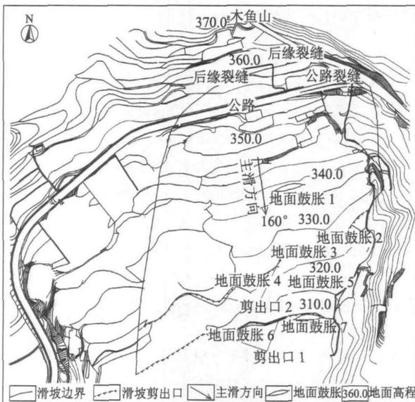
图1 土门子滑坡平面图
